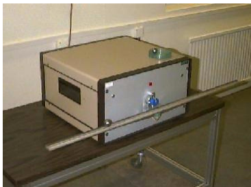
Labprocessen "Bommen". Syftet med processen är att reglera positionen på kulan.
