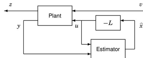
$$\text{Plant: } \begin{cases} \dot{x}(t) = Ax(t) + Bu(t) + v_1(t) \\ y(t) = Cx(t) + v_2(t) \end{cases}$$
