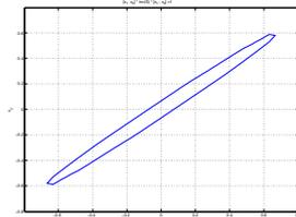
Plot of  $\begin{bmatrix} x_1 & x_2 \end{bmatrix} \cdot S^{-1} \begin{bmatrix} x_1 \\ x_2 \end{bmatrix} = 1$
