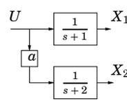
$$\text{System } \dot{x} = \begin{bmatrix} -1 & 0 \\ 0 & -2 \end{bmatrix} x + \begin{bmatrix} 1 \\ a \end{bmatrix} u$$
