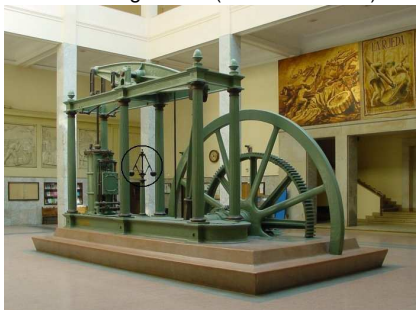
Watts ångmaskin (första från 1775)
